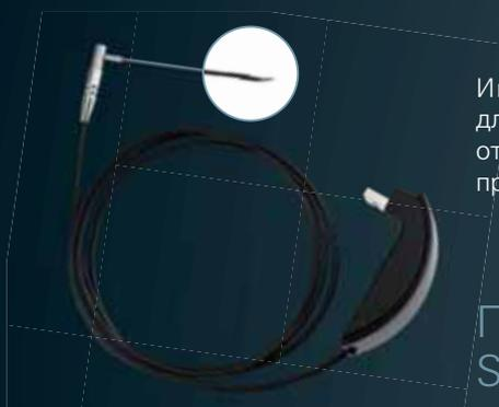
Игла USB-термощупа имеет диаметр всего 1 мм, длину 60 мм и острый скошенный срез – это позволяет отслеживать температурную динамику в готовящемся продукте, не нарушая при этом вакуум в пакете.
