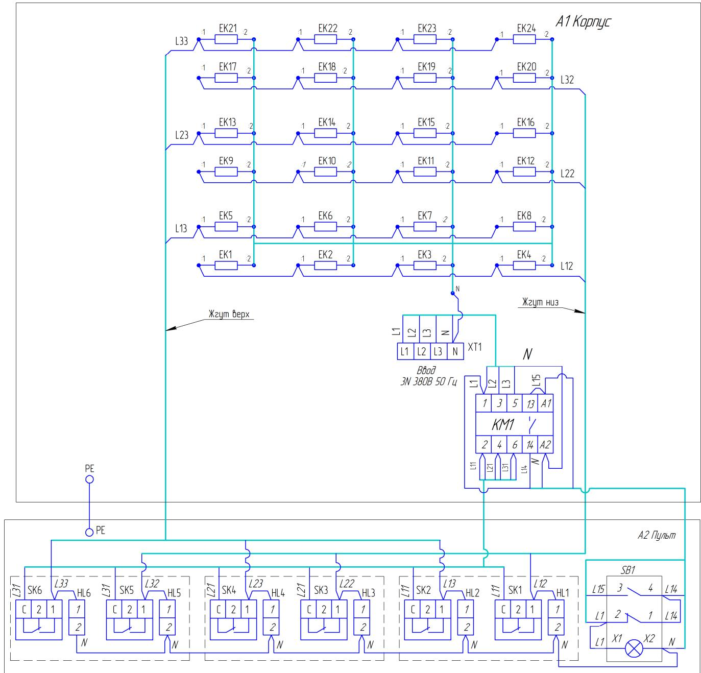
Рисунок 4 – Схема электрическая соединений печи
